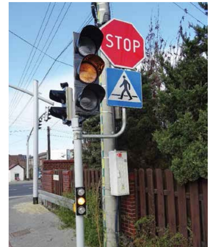
Zdjęcie 51 Sygnalizator pomocniczy o średnicy 100 mm. Polska, Gliwice
