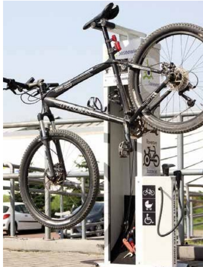
Zdjęcie 68 Samoobsługowa stacja naprawcza. Sosnowiec, Polska
