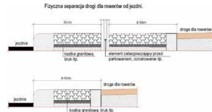
Schemat 6 Przykładowa separacja drogi dla rowerów od jezdni
