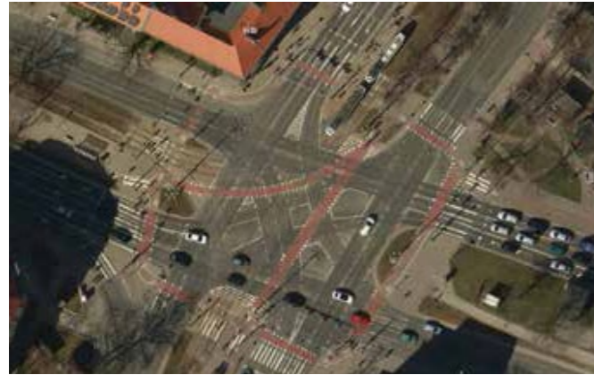
Zdjęcie 52 Ukośny przejazd rowerowy. Polska, Wrocław
