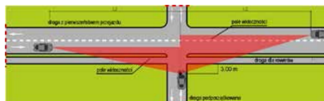
Rysunek 7 Odległość widoczności na skrzyżowaniach dróg dla rowerów z pierwszeństwem
