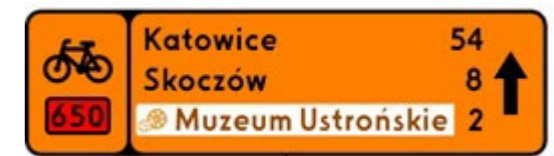
Rysunek 33 Znak R-4c zapewniający możliwość oznakowania atrakcji/obiektów turystycznych leżących na trasie rowerowej.
