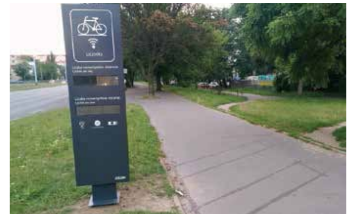
Zdjęcie 67 Licznik rowerzystów wraz z pętlą indukcyjną. Łódź, Polska
