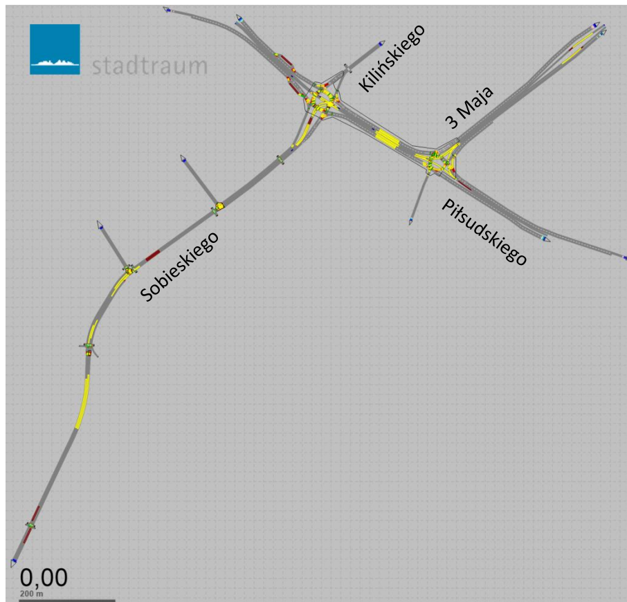
Rys. 95. Struktura modelu mikrosymulacyjnego dla odcinka W20-W21 linii T15 w narzędziu PTV Vissim
