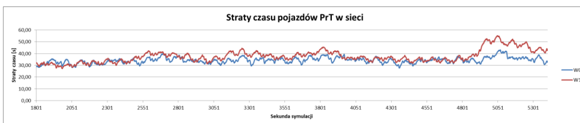
Rys. 85. Zmienność strat czasu pojazdów transportu indywidualnego w modelowej sieci – Porównanie wariantów W0 i W1
