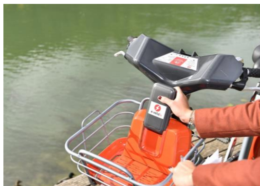
Rycina 11: Przenośna bateria w rowerze hybrydowym systemu Vélo'v z Lyonu
