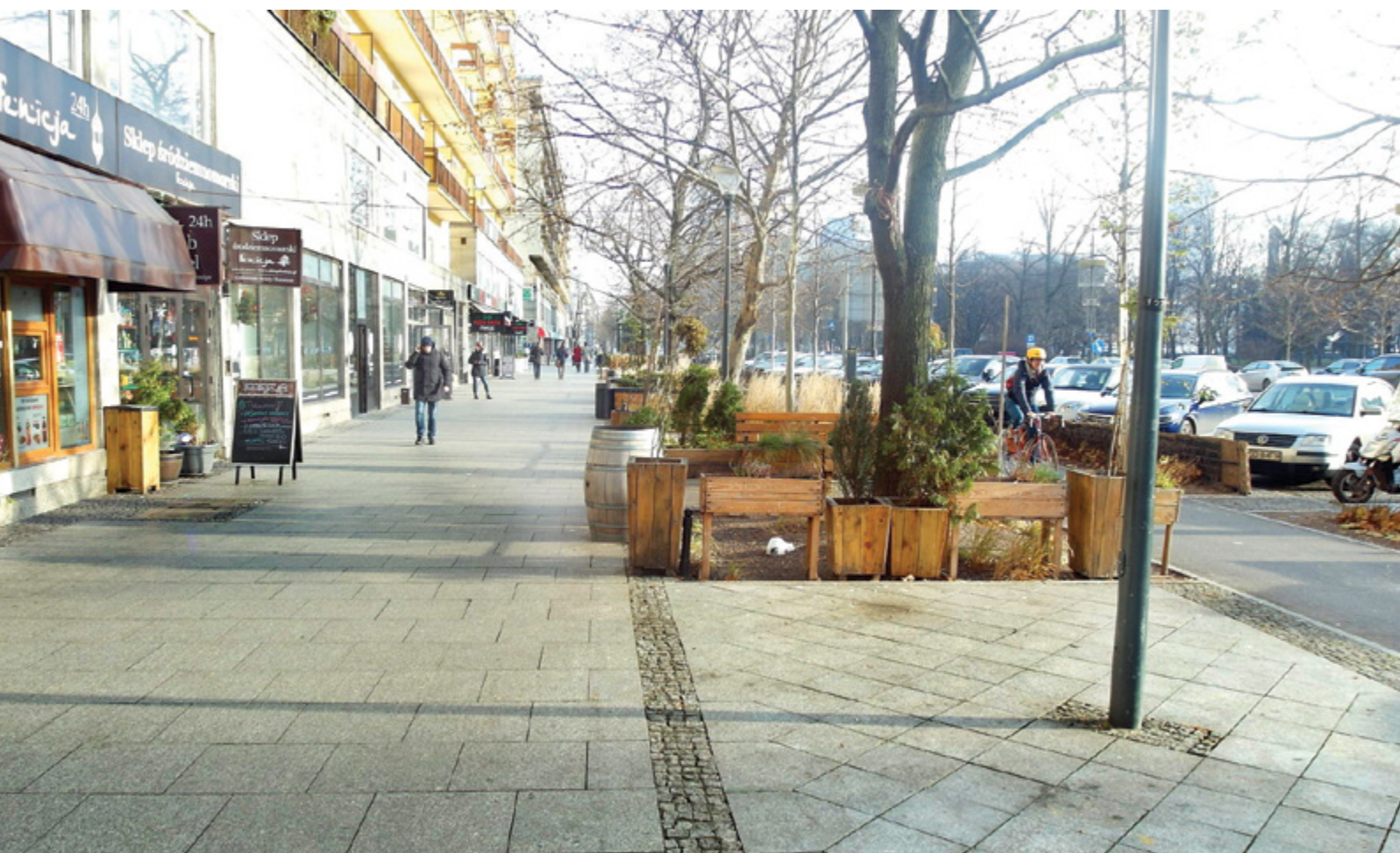
Chodnik z pasami buforowymi oraz z pasem funkcji pozakomunikacyjnych. Warszawa, ul. Świętokrzyska (fot. Grzegorz Wójkowski)
