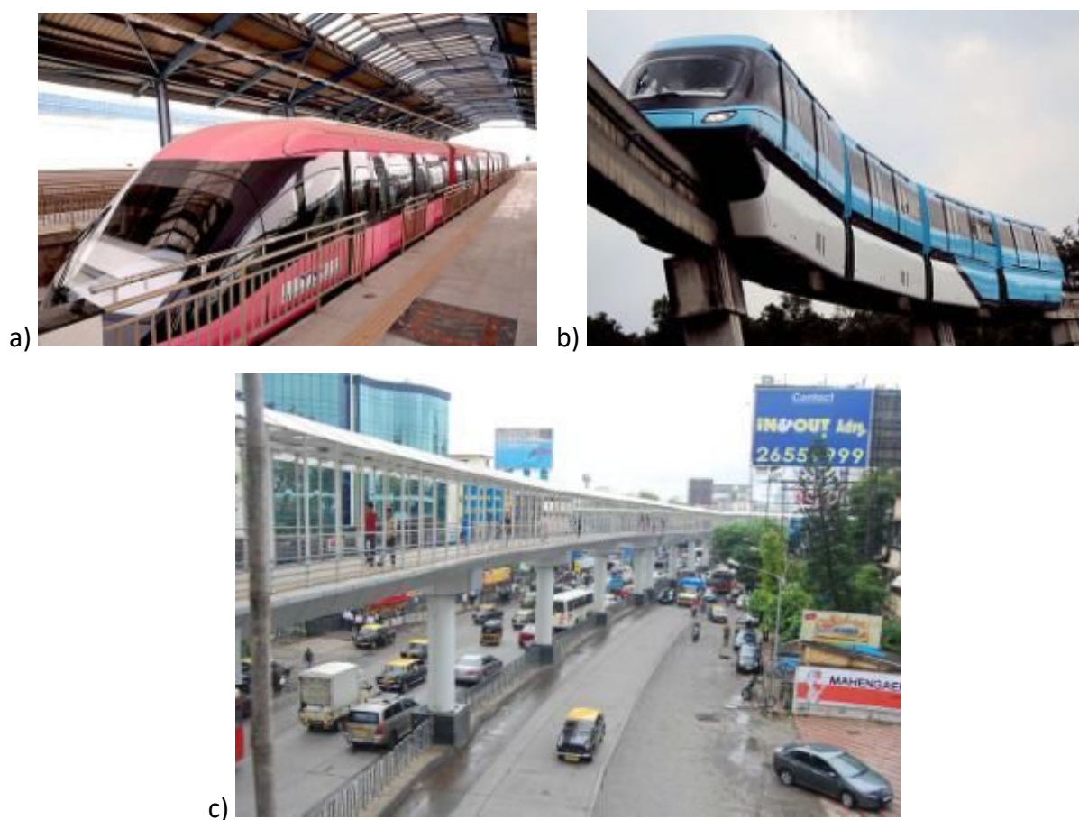
Rys. 6.1. Przykłady elementów systemu Monorail Mumbai: a) Pociąg wjeżdżający na peron, b) Widok torowiska i sposobu oparcia taboru, c) Widok kładki łączącej w sposób bezpośredni stację kolei podmiejskiej z przystankiem monorail
