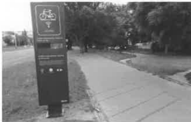
Zdjęcie 67 Licznik rowerzystów wraz z pętlą indukcyjną. Łódź, Polska
